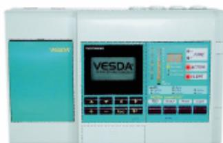
Detector de humos por aspiración de alta sensibilidad para 1 zona de máximo 200m lineales de tubería con tecnología láser, Vesda Láser Plus. Superficie de cobertura a proteger 2000m<sup>2</sup> máx., con salida de relés (Alerta, Acción, Fuego 1, Fuego 2 y Avería) y tarjeta de red VESDANET. Además incluye módulo de control y barra gráfica de LEDs y programador del equipo con display. Requiere alimentación exterior 24Vcc.
