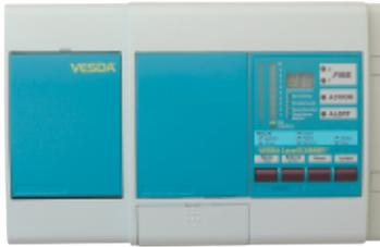
Detector de humos por aspiración de alta sensibilidad para 4 zonas independientes de máximo 200m lineales de tubería con tecnología láser, Vesda Láser Plus. Superficie de cobertura a proteger 2000m<sup>2</sup> máx., con salida de relés (Alerta, Acción, Fuego 1, Fuego 2 y Avería), por zona, y tarjeta de red VESDANET. Además incluye módulo de control y barra gráfica de LEDs. Requiere alimentación exterior 24Vcc.
