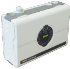
Detector de humos por aspiración, de alta sensibilidad con tecnología láser, Vesda Láser Focus para 1 tubería 50m lineales. Superficie de cobertura a proteger 500m<sup>2</sup> máx., con salida de relés (Acción, Fuego, y Avería). Requiere alimentación exterior 24Vdc.
