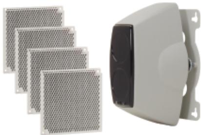
Barrera óptica de humos con emisor y receptor integrado en el mismo equipo. Alcance de 35 a 100m. Incorpora relé de alarma y avería. Protección IP50. Control automático de ganancia y sensibilidad ajustable entre 25%, 35% y 50% de oscurecimiento por metro. Alimentación 12 a 24Vcc.
