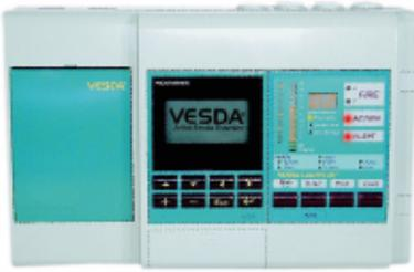
Detector de humos por aspiración de alta sensibilidad para 4 zonas independientes de máximo 200m lineales de tubería con tecnología láser, Vesda Láser Plus. Superficie de cobertura a proteger 2000m<sup>2</sup> máx., con salida de relés (Alerta, Acción, Fuego 1, Fuego 2 y Avería), por zona, y tarjeta de red VESDANET. Además incluye módulo de control y barra gráfica de LEDs y programador del equipo con display. Requiere alimentación exterior 24Vcc.
