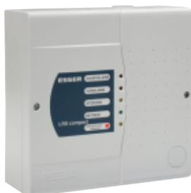
Detector de humos por aspiración de alta sensibilidad para 1 zona de máximo 100m lineales de tubería con tecnología láser, Vesda Láser Compact. Superficie de cobertura a proteger (800m<sup>2</sup> máx.), con salida de relés (Prealarma, Fuego y Avería). Requiere alimentación exterior 24Vcc.
