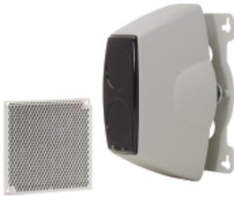
Barrera óptica de humos con emisor y receptor integrado en el mismo equipo. Alcance de 10 a 50m. Incorpora relé de alarma y avería. Protección IP50. Control automático de ganancia y sensibilidad ajustable entre 25%, 35% y 50% de oscurecimiento por metro. Alimentación 12 a 24Vcc.
