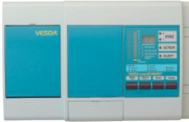
Detector de humos por aspiración de alta sensibilidad para 1 zona de máximo 200m lineales de tubería con tecnología láser, Vesda Láser Plus. Superficie de cobertura a proteger 2000m<sup>2</sup> máx., con salida de relés (Alerta, Acción, Fuego 1, Fuego 2 y Avería) y tarjeta de red VESDANET. Además incluye módulo de control y barra gráfica de LED's. Requiere alimentación exterior 24Vcc.
