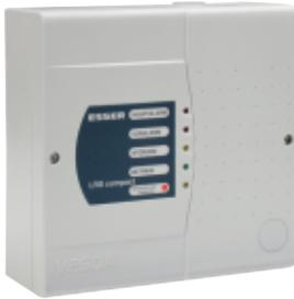
Detector de humos por aspiración de alta sensibilidad para 1 zona de máximo 100m lineales de tubería con tecnología láser, Vesda Láser Compact. Superficie de cobertura a proteger 800m<sup>2</sup> máx., con salida de relés (Prealarma, Fuego y Avería) y tarjeta de red VESDANET. Requiere alimentación exterior 24Vcc.
